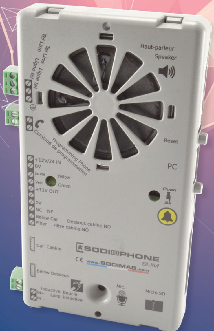
La téléalarme SODI@PHONE Slim est un téléphone d'ascenseur qui relie l'ascenseur au centre d'appel du client en France ou à l'étranger. Il fournit une communication bidirectionnelle entre le centre d'appel et la cabine de l'ascenseur. De plus, il peut être raccordé au réseau téléphonique via une ligne téléphonique RTC ou GSM.
